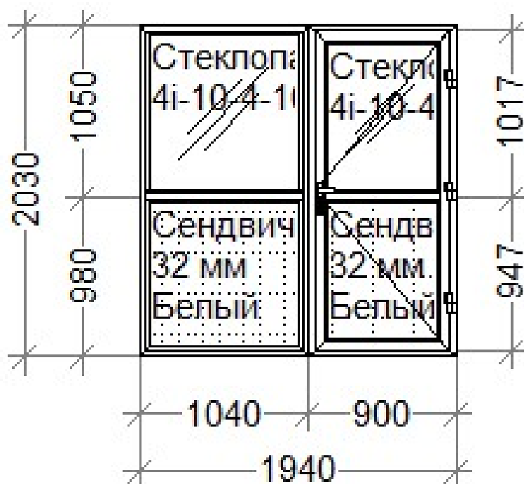
Креслення № 4. Другі енергозберігаючі двері на переході з поверху до виходу на запасний/пожежний вихід Другого парадного будинку № 5 по вул. Флоренції м. Києва
